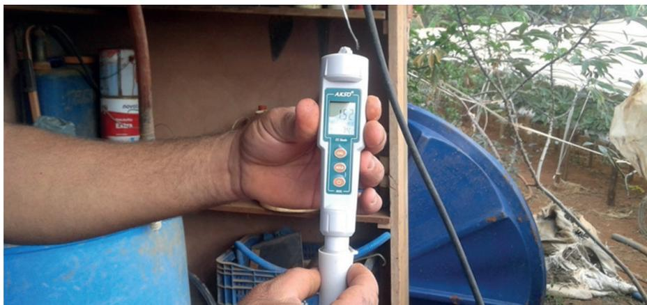
**Figura 30.** Uso do Condutivímetro para medição da condutividade elétrica (EC) de soluções.
